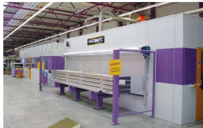
Vom Profil zur fertigen Crashbox in 12 Arbeitsschritten
