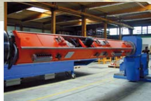
Grundaufnahme für das Mandrel
