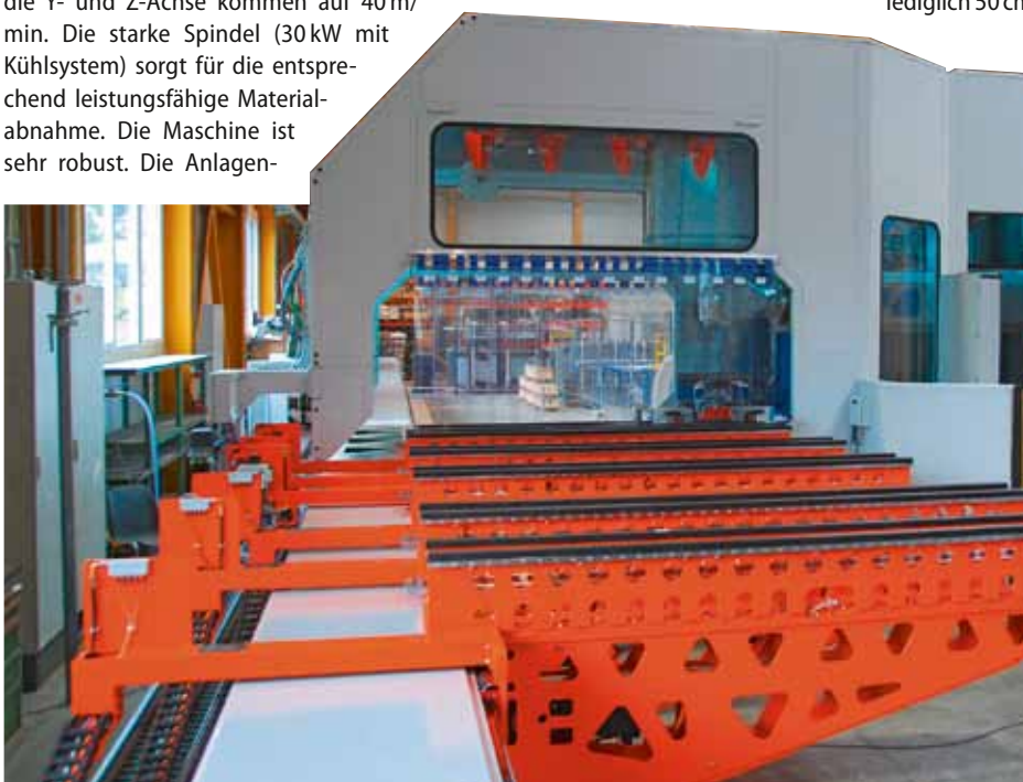
Das Hagewood-Abbundzentrum ABZ 605 ist im Regelbetrieb für bis zu 20 m lange Elemente ausgelegt
