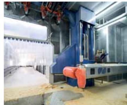
Flexible Bearbeitung in kürzester Zeit: Neben dem 20-fachen Standardwerkzeugwechsler verfügt die Anlage auch über vier Sonderwerkzeugwechsler.
