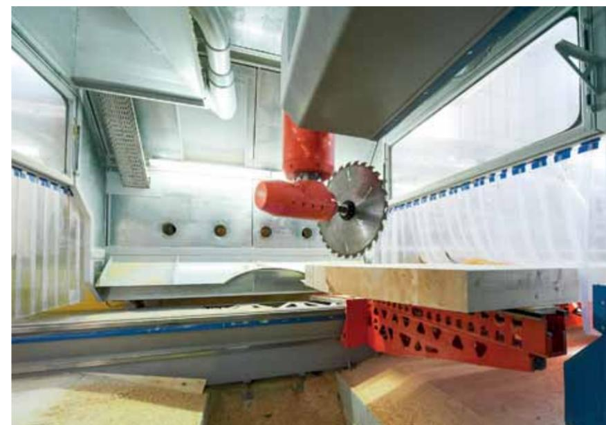
Das Herzstück: die vierachsig verstellbare Spindel. Sie läuft auch für Freiformen mit Höchstgeschwindigkeit von 12.000 U/min. Die Spannwagen können auf bis zu 80 m/min beschleunigen.
