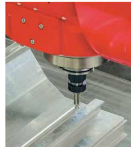
Ein hybrider Bearbeitungskopf ermöglicht sowohl Fräs- als auch FSW-Prozesse.
