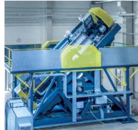
Auf dem in zwei Achsen +/- 50° schwenkbaren Motorenprüfstand wird die Geländetauglichkeit von Motoren für Geländefahrzeuge getestet. Auch dynamische Anlagenkonzepte für Rennmotoren sind möglich.
