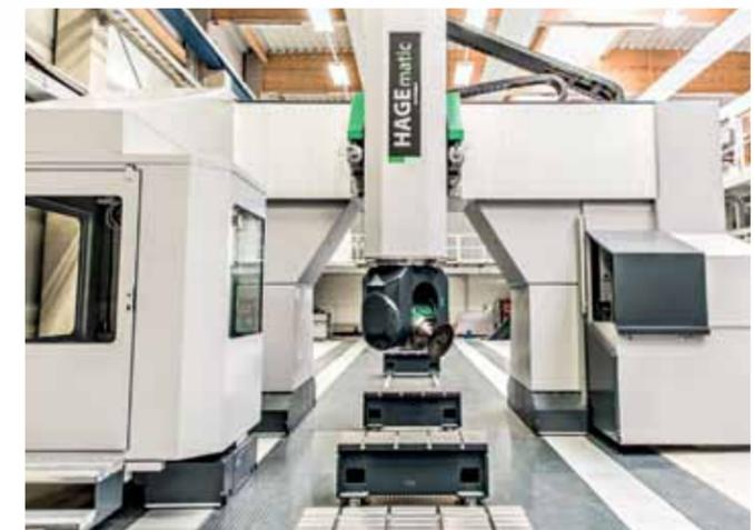
Mit der innovativen HAGEmatic FSW können Werkstücke sowohl spanend bearbeitet als auch verschweißt werden.
