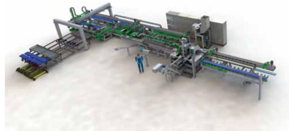
Mit Hilfe der präzisen HAGEspecial-Anlage werden verschiedenste Tür-Zargen in Serie oder mit einer Losgröße vollautomatisch gesägt, gestanzt und entgratet.
