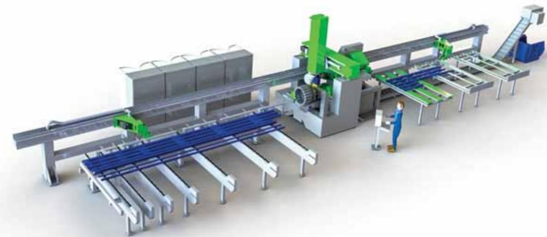
Die HAGEmatic Flexible ermöglicht das Bearbeiten von gleich sechs Seiten der Alu- und Stahlprofile in einem Durchlauf.
