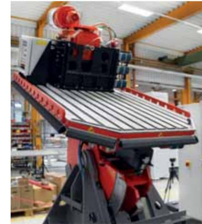
Schwenkprüfstand zum Testen von Auto-Verteilergetrieben sowie Vorder- und Hinterradgetrieben. Als Antriebs- und Prüfmotor wurde ein 30KW-Oswald-Motor (0-12.000 Umdrehungen) eingesetzt.
