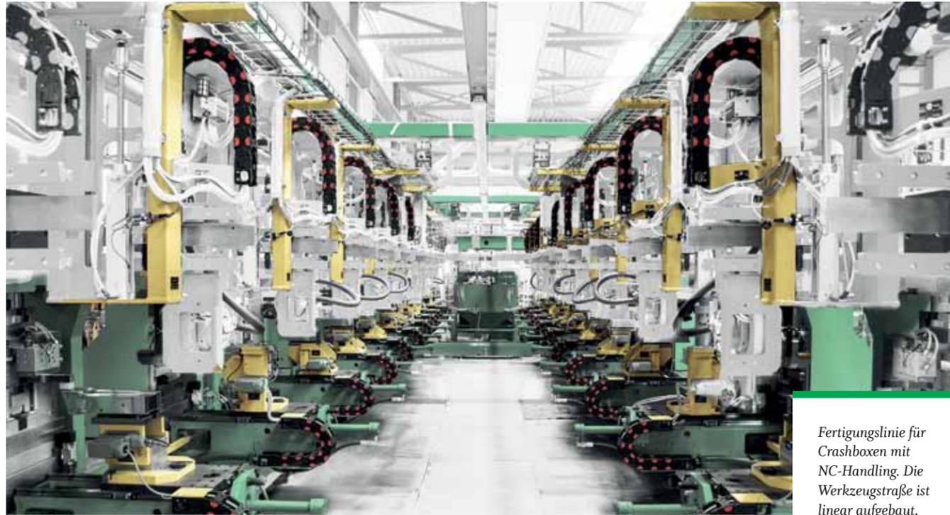
Fertigungslinie für Crashboxen mit NC-Handling. Die Werkzeugstraße ist linear aufgebaut.
