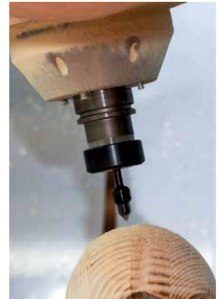
Die Werkstücke werden durch eine 6-Seiten-Bearbeitung ohne Winkelköpfe und ohne Umspannen bearbeitet.
