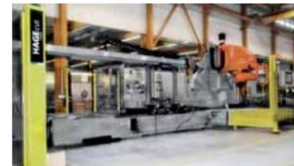
Hightech-Sägeanlage für die Bearbeitung von Traktorkabinen.
