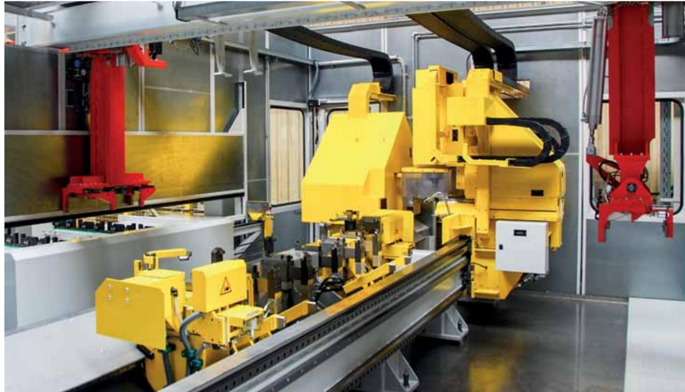
**FERTIGUNGSANLAGE FÜR BAUSTÜTZEN-AUSSENROHRE AUTOMATISCH VERARBEITET**
