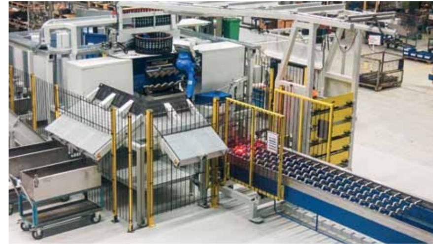
Beispiel einer vollautomatisierten 5-Achs-HAGEcut mit Roboterhandling für hydrogeformte Rohre aus Edelstahl und Nickelbasislegierungen.
