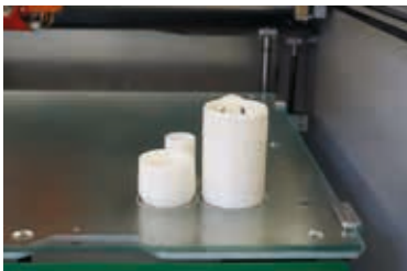
Additiv gefertigte Komponenten für das Beatmungsgerät mit dem 3D-Drucker von HAGE3D.
